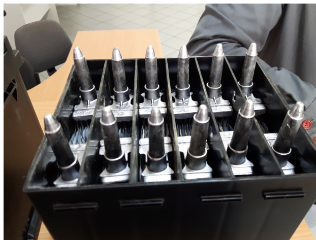
Figura 2: Produs: model experimental nou pentru acumulatori plumb-acid
