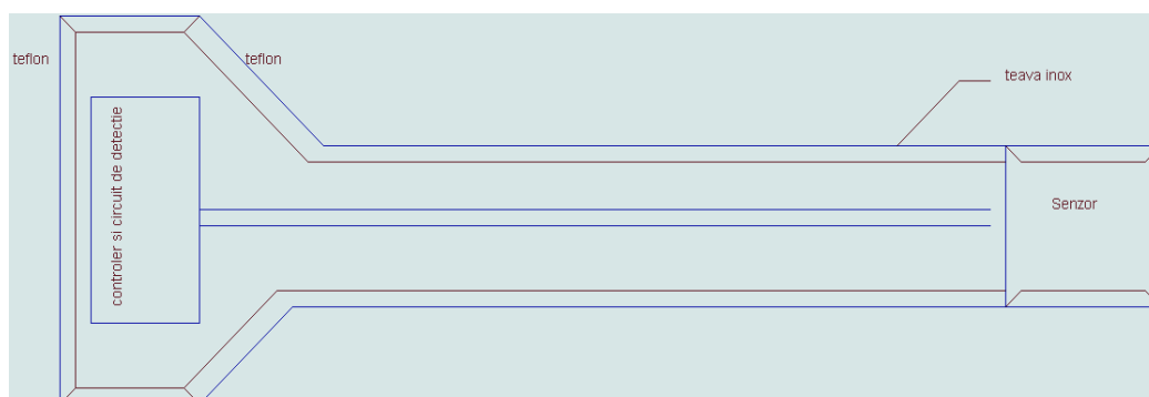
Fig.9. Schiță construcție echipament încapsulare senzor
