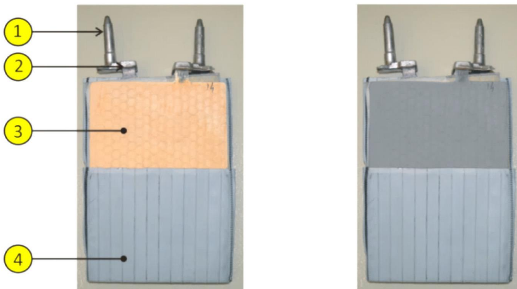
Fig. 5. Grilă de electrod hexagonală: (stânga) înainte și (dreapta) după formare; Notațiile se referă la: (1) terminalul de ieșire; (2) electrodul de contact al mai multor electrozi (5 electrozi/grup); (3) grilă-electrod experimental cu model hexagonal; (4) membrana polimerică separatoare;
