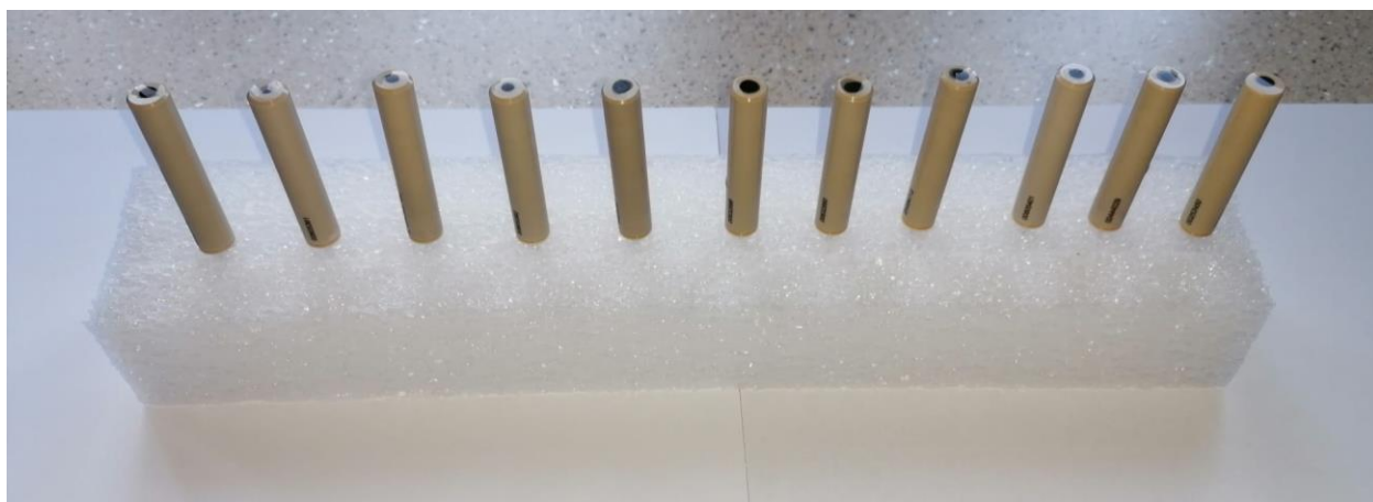
Figura 10. Electrozi de carbune sticlos avand suprafata activa modificata cu diferite cantitati de material exfoliat EXF pe baza de chitosan si grafene
