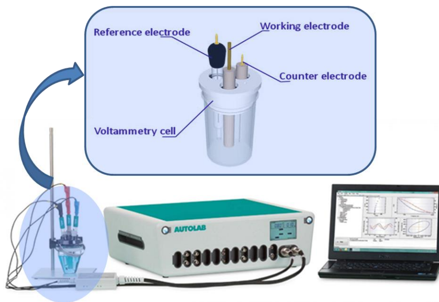
Figura 1. Set-up experimental pentru măsurători voltametrice. Celula electrochimică cu elementele de baza (electrod de lucru, contra-electrod, electrod de referință) imersate în soluția de analit
