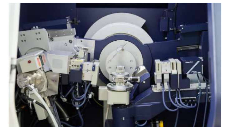
Difractometru de raze X pentru pulberi și filme subțiri
