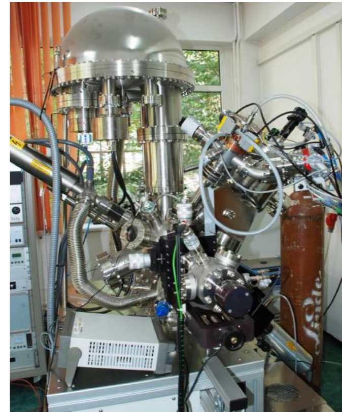
Spectrometru de fotoelectroni cu excitare de raze X (XPS) și UV (UPS)
