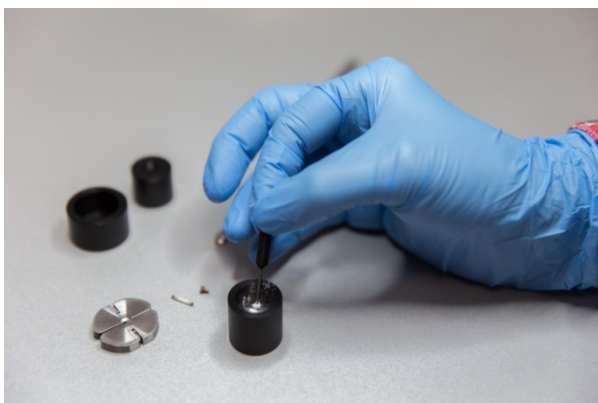
Introducerea probei (pulbere) în rotor.
