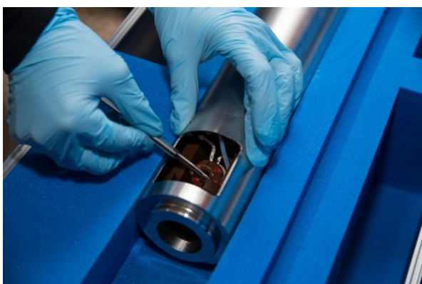
Cap de probă RMN pe probe solide.
